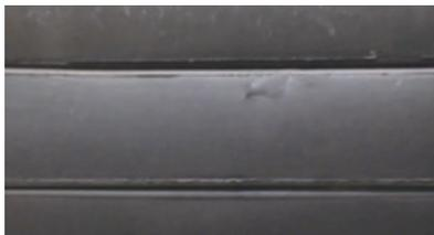
EPDM (他社の耐候性ケーブルグランドで使用しているもの) 外観：亀裂が発生し、変色が大きく、粉状の物質が表面に出ている。
